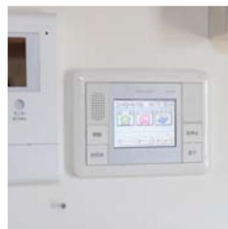
家庭内の電化製品をネットワーク化するホーム・エネルギー・マネジメント・システム(HEMS)のモニター画面。電力の使用状況が「見える化」できる。
